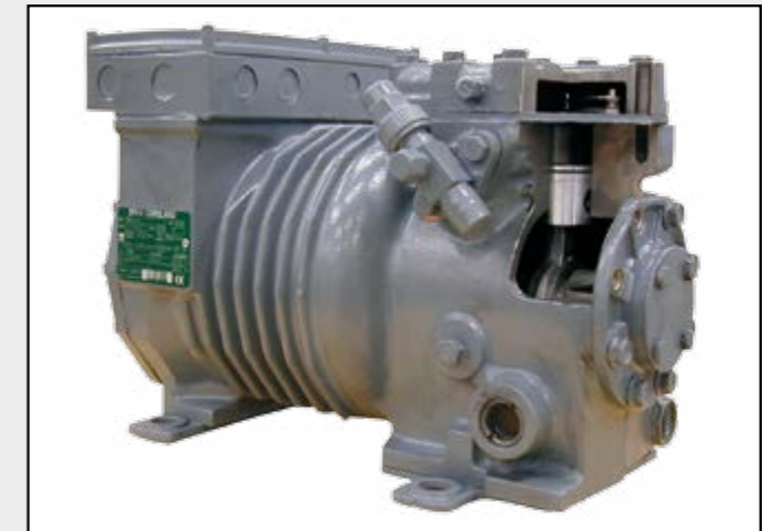
ET 499.02 Semi-Hermetic Refrigerant Compressor
